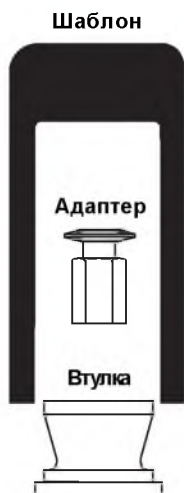
Рис. 5 Переходник для клапанов LE и KE поставляется с приводом. Используйте приложенный к приводу шаблон для сборки привода с клапаном
