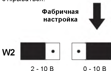
Рис. 36 Настройка диапазона входного сигнала.
